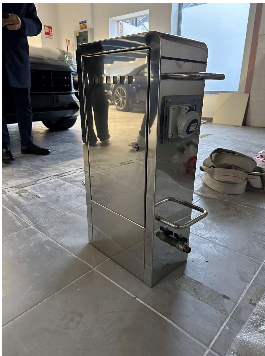
Foto 3: Erogatore servizi "EROMAR 3" 2 utenze in acciaio inox AISI 313: 2 prese 16A-230V /2WT ½" con sistema di contabilizzazione (Prese EPOWER, controllo consumo energie elettrica e idrico, sistema prepagato) e morsettiere entra/esci per cavi fino a 50 mm.
