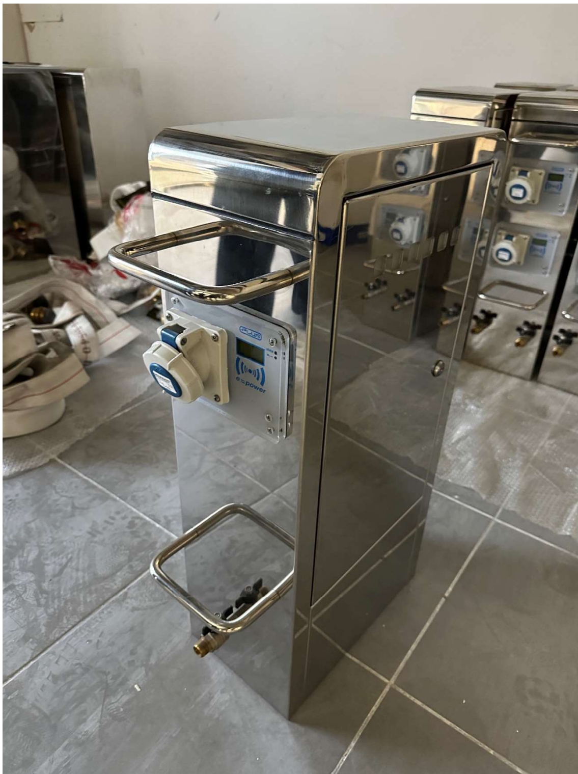
Foto 4: Erogatore servizi "EROMAR 3" 2 utenze in acciaio inox AISI 313: 2 prese 16A-230V /2WT ½" con sistema di contabilizzazione (Prese EPOWER, controllo consumo energie elettrica e idrico, sistema prepagato) e morsettiere entra/esci per cavi fino a 50 mm
