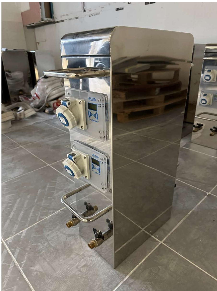
Foto 1: Erogatore servizi "EROMAR 3" 4 utenze in acciaio inox AISI 313: 4 prese 16A-230V /4WT ½" con sistema di contabilizzazione (Prese EPOWER, controllo consumo energie elettrica e idrico, sistema prepagato) e morsettiere entra/esci per cavi fino a 50 mmq
