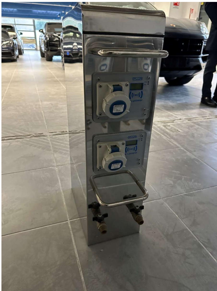
Foto 2. Erogatore servizi “EROMAR 3” 4 utenze in acciaio inox AISI 313: 4 prese 16A-230V /4WT ½” con sistema di contabilizzazione (Prese EPOWER, controllo consumo energie elettrica e idrico, sistema prepagato) e morsettiere entra/esci per cavi fino a 50 mm
